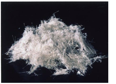
出典：国土交通省「建築物のアスベスト対策」 茶石綿
