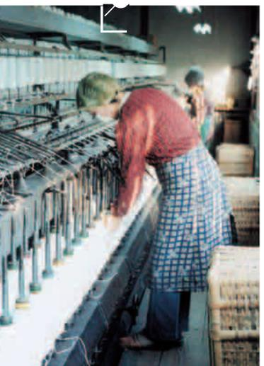
●写真は、石綿紡織の工程のなかで、撚糸(ねんし インター)という工程です。精紡のできた単糸を2~5本を合わせて撚りをかける工程です。この写真ではマスクをしています。糸が切れたり機械とこすれて大量の石綿粉じんが発生しました。
